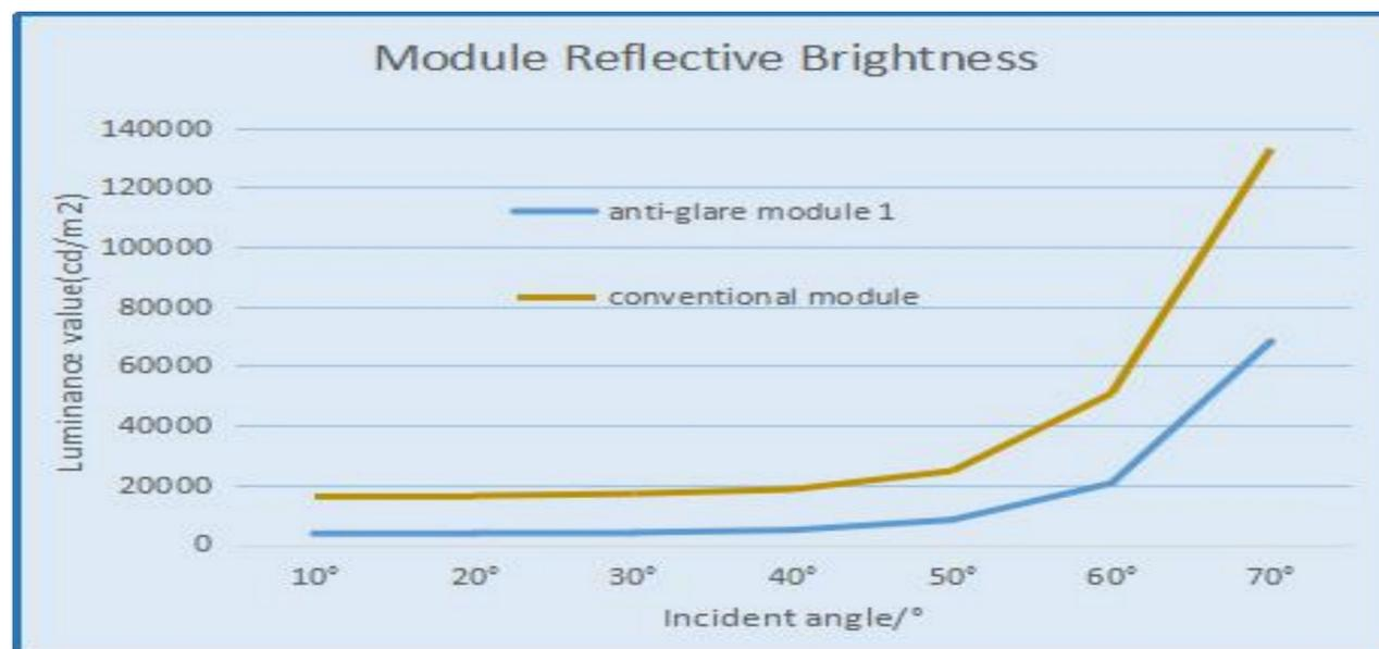
普通モジュールと防眩モジュールの光反射率(眩しさ)
