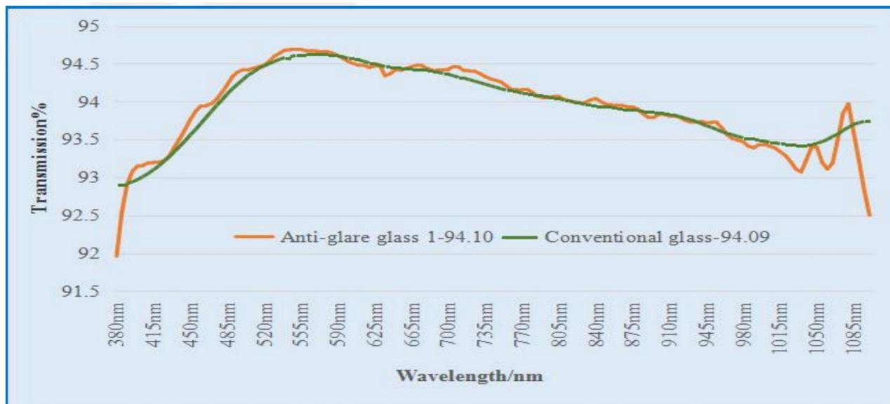
普通モジュールと防眩モジュールの光通過率(発電効率)
